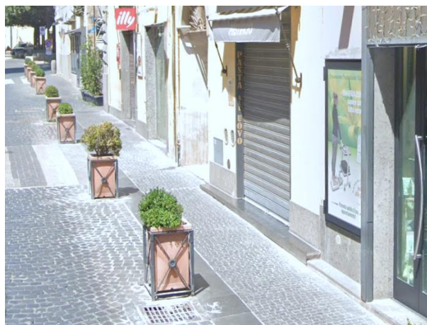
Protezione di percorso pedonale a raso (Fioriera) – Via Alcide De Gasperi (Albano Laziale)
